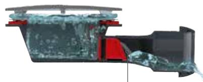
La membrana silicone si apre al passaggio dell'acqua, dopodiché si richiude per impedire la risalita di cattivi odori.
