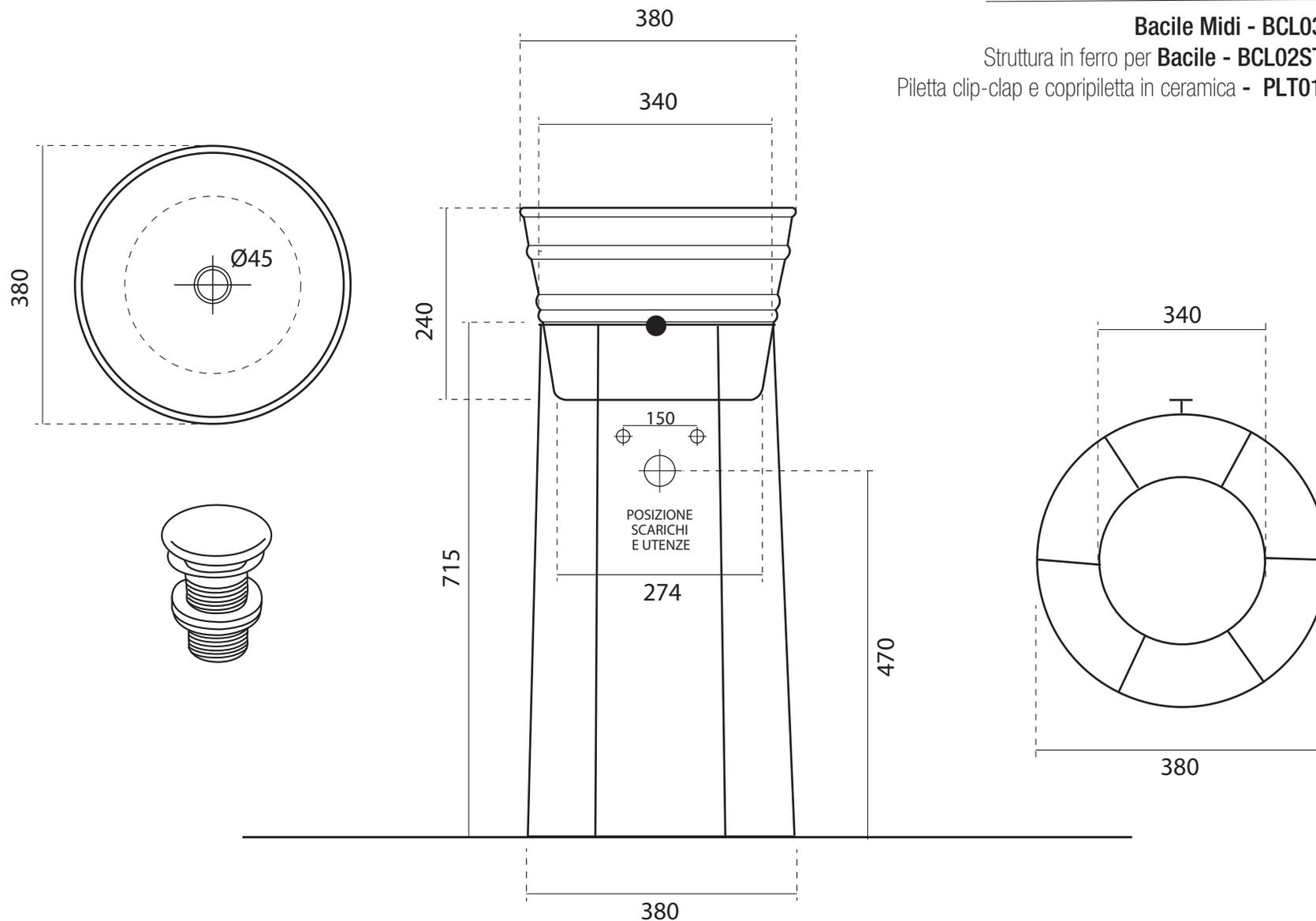
N.B. Le misure indicate possono subire una variazione del 2% circa, dovuta ad usura stampi e a variazioni delle caratteristiche tecniche relative alle materie prime che compongono l'impasto
